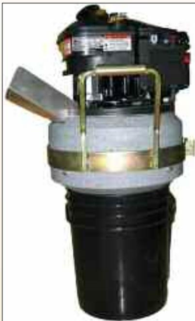
Дробилка портативная для размалывания золотосодержащих пород.
